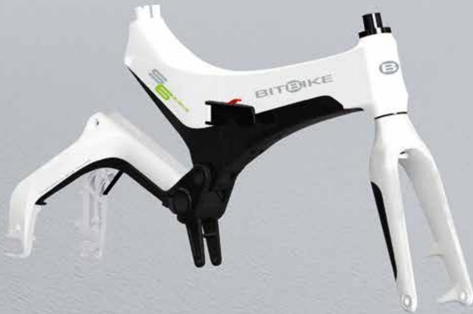
Il materiale del telaio è in lega di magnesio, che è 1/3 più leggero della lega di alluminio e ha una migliore resistenza agli urti. Il processo del telaio adotta la tecnologia della pressofusione della lega di magnesio, che rompe il tradizionale processo di saldatura e garantisce che l'intera bicicletta elettrica non abbia saldature.
