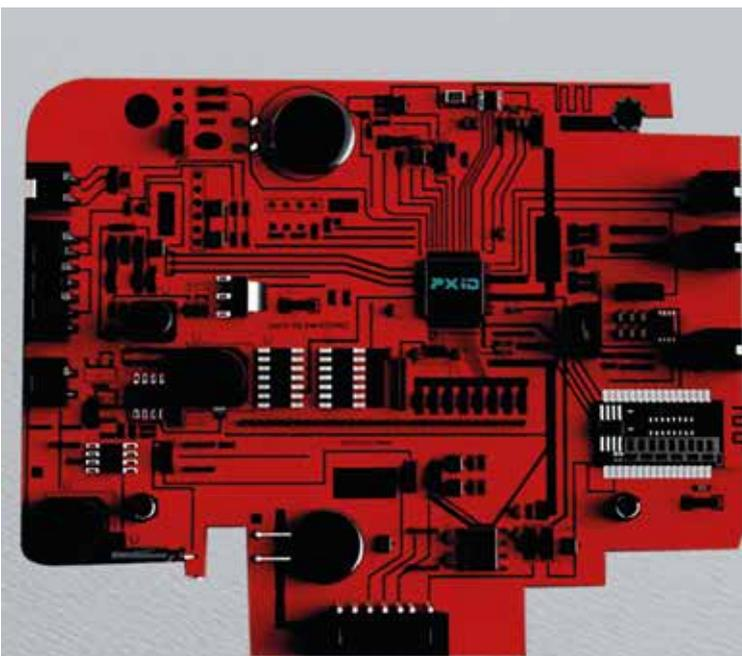
Il motore da 250 watt/36 volt è controllato da una centralina elettronica (Controller) che, in base al livello di assistenza prescelto e dallo sforzo del ciclista sui pedali, eroga una determinata quantità di potenza. In pratica, con un elevato sforzo e/o frequenza di pedalata, l'assistenza del motore elettrico sarà maggiore. Il controller di cui è dotata questa bici è equipaggiato dal potente chip PXID di ultima generazione.
