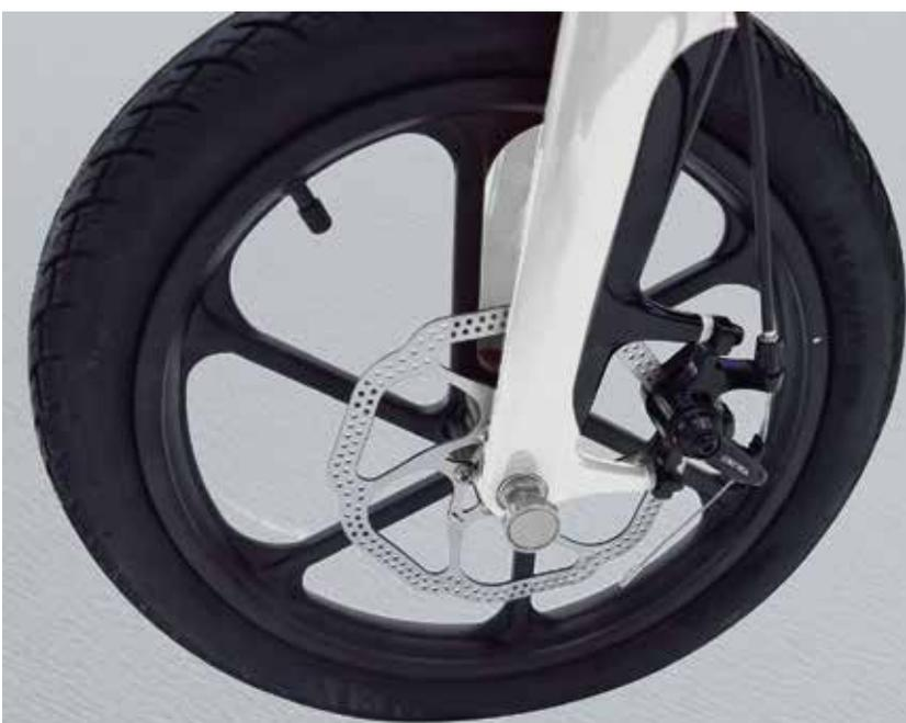
Un occhio alla sicurezza: Gli spazi di frenata di un veicolo sono fondamentali per la sicurezza, e pertanto questa bicicletta è equipaggiata di freno a disco anteriore e posteriore con pinza a comando meccanico. Questo tipo di freno consente spazi di arresto limitati in qualsiasi condizione. La conformità del disco a margherita oltre al fattore estetico permette una maggiore dissipazione del calore e della polvere che si crea sulla superficie frenante del disco.
