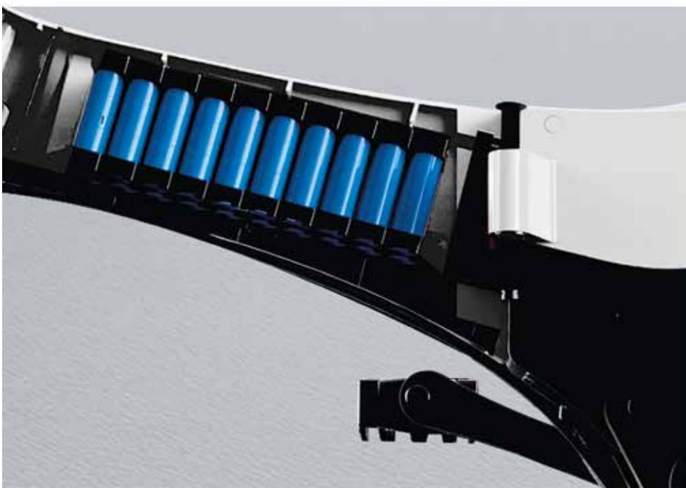
Batterie al Litio: sul mercato oggi sono quelle più utilizzate perchè di piccole dimensioni e più leggere, con maggior durata nel tempo. Lo standard delle batterie elettriche è 36 volt e 5,2 Ah, questa capacità garantisce un'autonomia di circa 55 km, che può variare in base allo sforzo del ciclista sui pedali e dal livello di selezione di potenza sul controllo manubrio. Questo modello di bici ha la batteria estraibile una volta aperto il telaio con slot antifurto a chiave.
